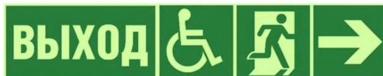
Рисунок 5 — Пример комбинации эвакуационных знаков
